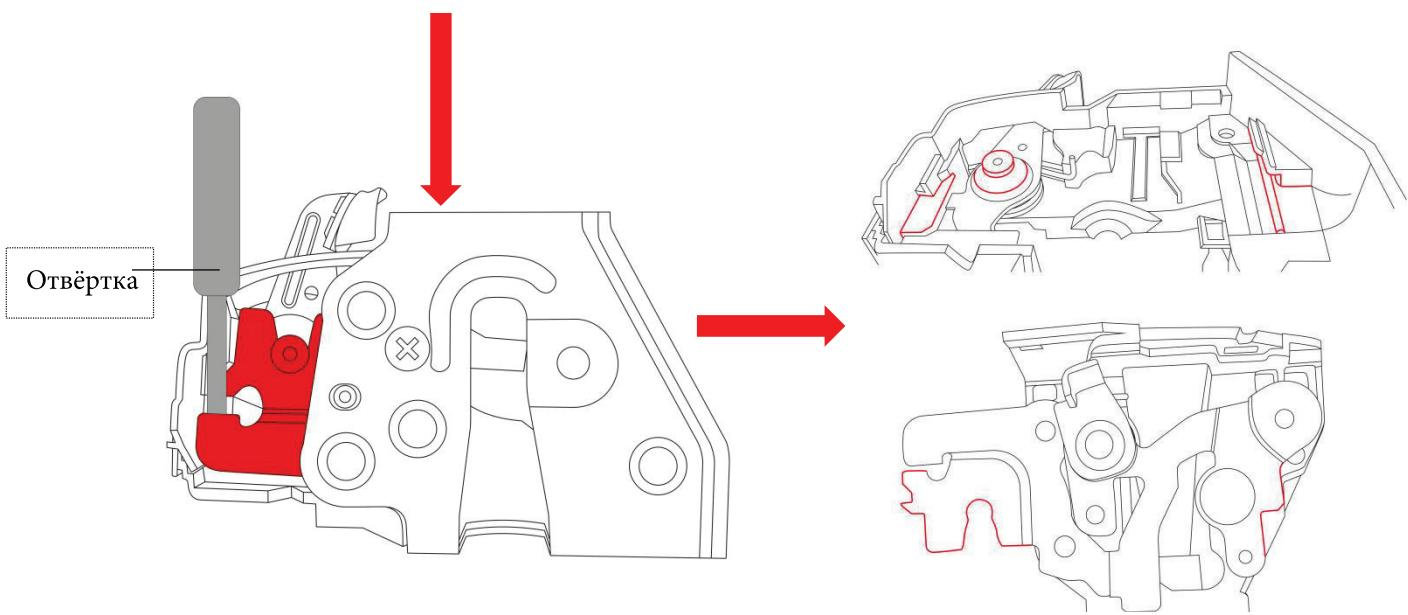
Для разединения механической и электрической частей замка воспользуйтесь отвёрткой
