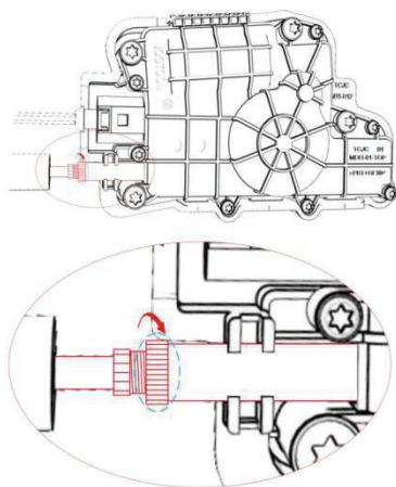
При необходимости отрегулируйте "преднатяг" доводчика с помощью регулировочной гайки.
